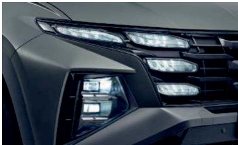
To'liq yorug'lik diodli bosh chiroqlar (keng yoritish burchagi va IFS yorug'likni intellektual boshqarish tizimi)
