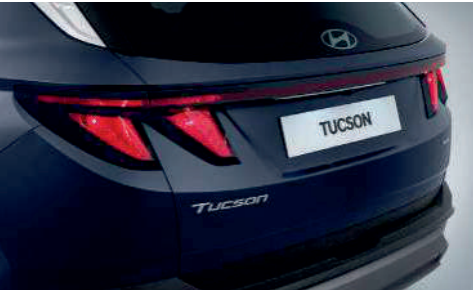
Kombinatsiyalangan orqa chiroqlar (galogen lampalari bilan)
